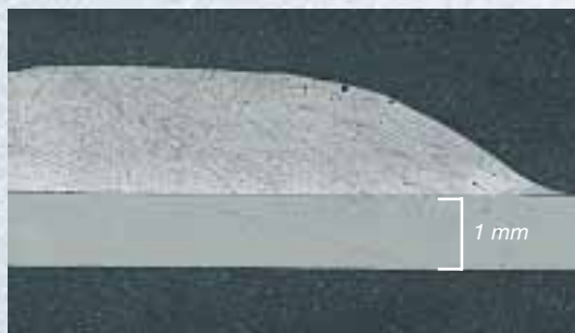
Spojování CMT oceli s hliníkem. Na straně hliníku svařeno, na straně oceli pájeno.
