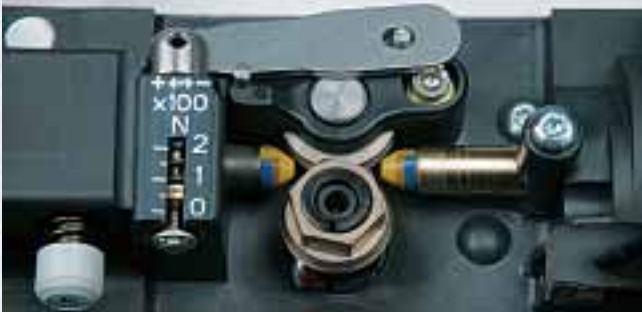
Nový pákový napínací systém ve svařovacím hořáku zajišťuje konstantní a reprodukovatelný přítlak.
