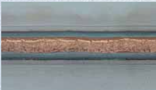
Pájené spojení CMT zároveň a elektrolyticky pozinkovaného plechu se svařovací rychlostí 2,0 m/min. Síla plechu 0,8 mm, přídatný materiál CuSi3.
