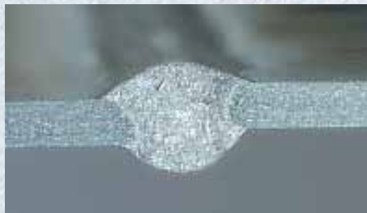
Tupý svar bez podložky lázně na plechu AlMg3 o síle 0,3 mm.
